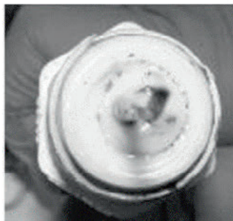
图 18.8.3: “通过” (左)和“未通过” (右)事件后“试验电池”的典型表现
